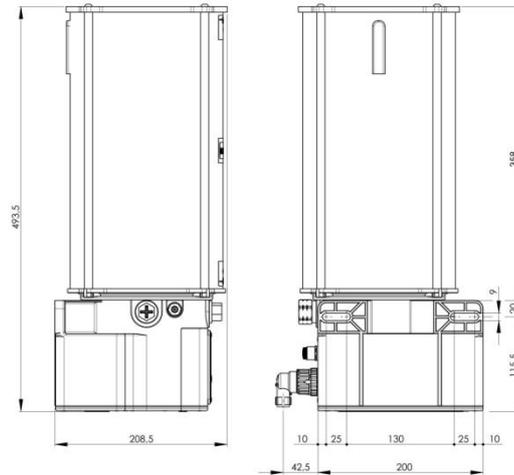
**GREASE ELECTRIC PUMP ILC-MAX-G 8 (115/230 V AC)**
