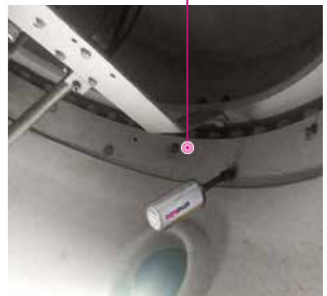
Automatische smering met een simalube 125 ml patroon op een rotorbladlager.
