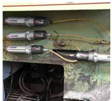
Dankzij de simalube IMPULSE drukversterker kunnen de smerpunten op de wikkelaar (lagers, geleidebussen en vergrendelingen) op afstand worden geïnstalleerd en via een slanginstallatie van smeermiddel worden voorzien.
