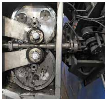
Twee simalube 60 ml patronen smeren automatisch een vliegende snijeenheid van de uitlijn- en snijmachine gedurende 6 maanden.
