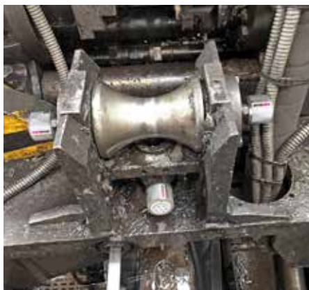
De kleine 30ml simalube patronen smeren de lagers en het hefsysteem van de geleiderol.
