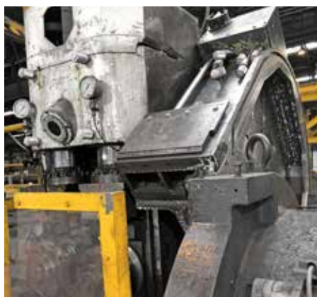
Meerdere simalube smeerpatronen en IMPULSE smeren de kolommen (links) en de aandrijfseenheid (rechts) van de ponsmachine.
