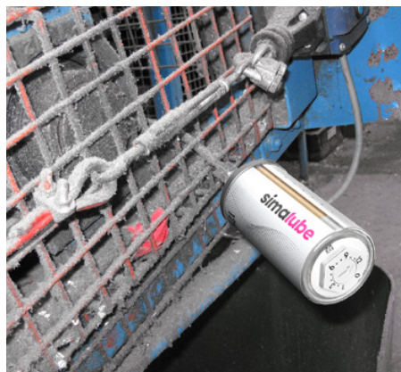
Het extern gemonteerde simalube smeerpatroon weerhoudt vuil ervan het smeerpunt binnen te dringen.
