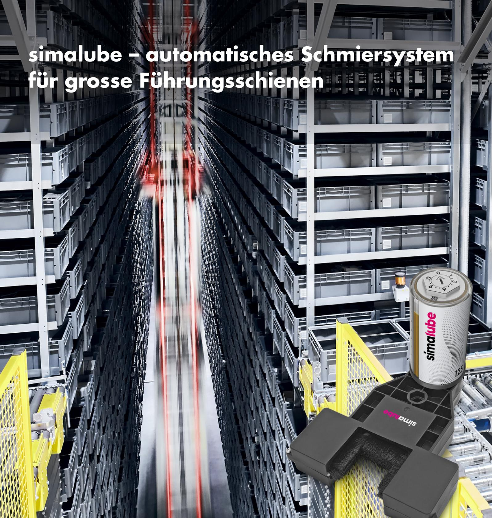
Das Schmieresystem, bestehend aus simalube und Spezialbürste, pflegt und schmiert grosse Führungsschienen automatisch und verhindert deren Trockenreibung. Es schützt die Schiene mit einem gleichmässigen Ölfilm und reinigt sie gleichzeitig. Die Laufzeit kann zwischen 1–12 Monaten frei gewählt und am simalube Schmierstoffgeber eingestellt werden.
