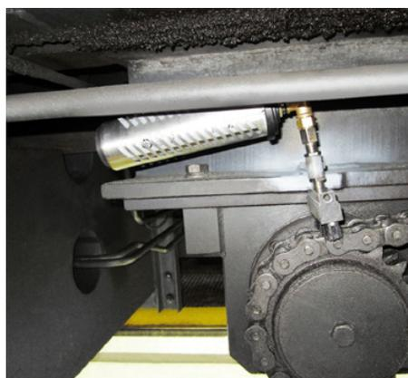
Un graisseur simalube 250ml lubrifie la chaîne d'entraînement d'une grue de chantier sur rails. À cette occasion, le graisseur est en outre protégé par un couvercle de protection.
