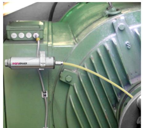
Grâce au graisseur simalube de 250 ml, le générateur est alimenté en continu avec la graisse jusqu'à 12 mois.
