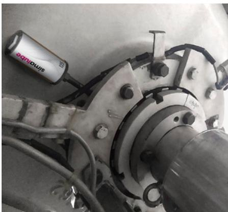
Avec les accessoires pratiques du simalube, il est facilement possible d'équiper chaque point de graissage avec un graisseur simalube.
