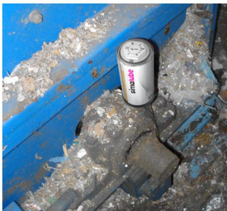
In einer Papierfabrik wird das Stehlager eines Schredders mit einem simalube 125 ml geschmiert.
